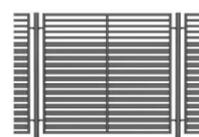
**9** Ограждения из труб (тип 015) высотой 2,1м
